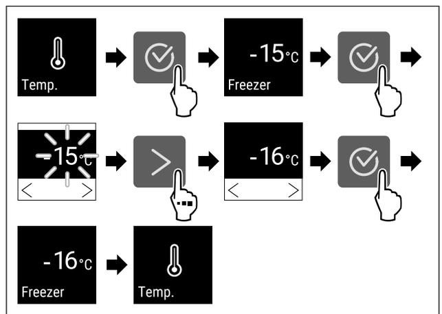
Fig. 68 Changement de température de -15 °C à -16 °C
